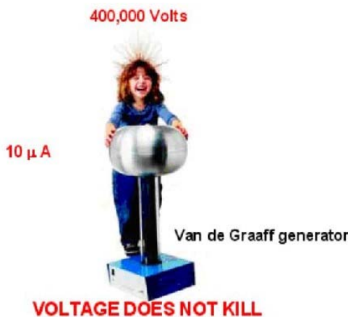
Illus. 1 Girl holding onto 400,000 volt Van de Graaff generator.
